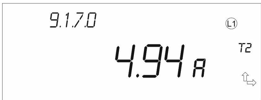
Пример отображения тока нуля
