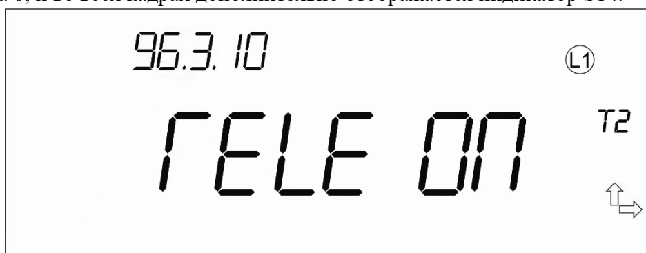
Рисунок 14. Кадр состояния включенного реле
