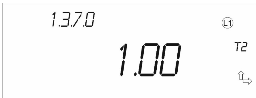
Пример отображения коэффициента мощности
