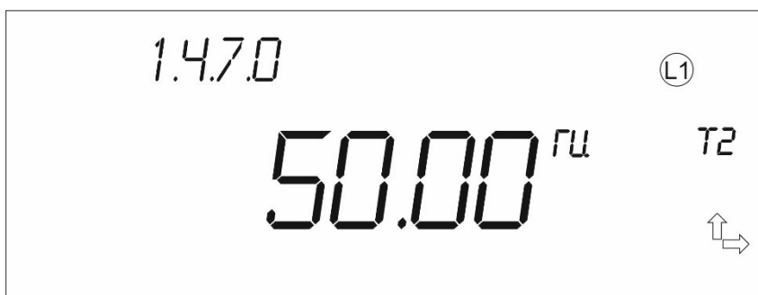
Пример отображения частоты сети
