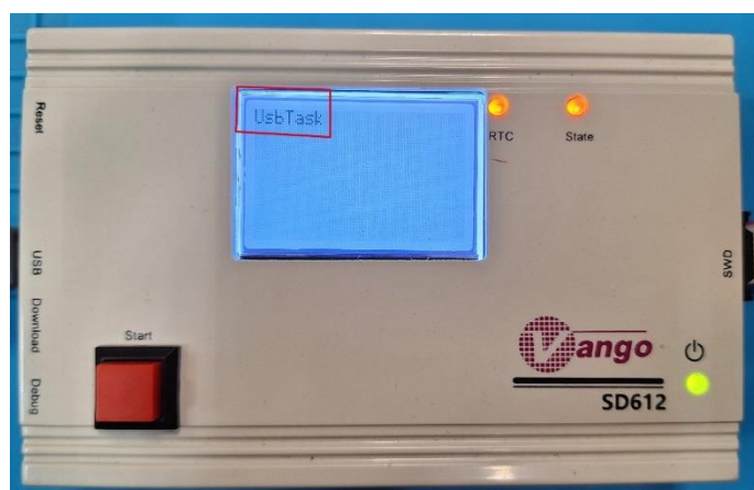
Рис. 11 – Индикация готовности программатора к работе с ПО HexWriter_SD612
